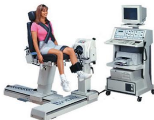
Рисунок 7 – Динамометрическая платформа и изокинетический динамометр.
