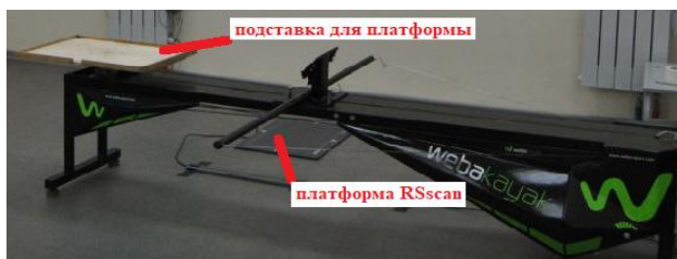
Рисунок 1 – Конструкция с установленной тензоплатформой на гребной эргометр Weba-Kajak.
