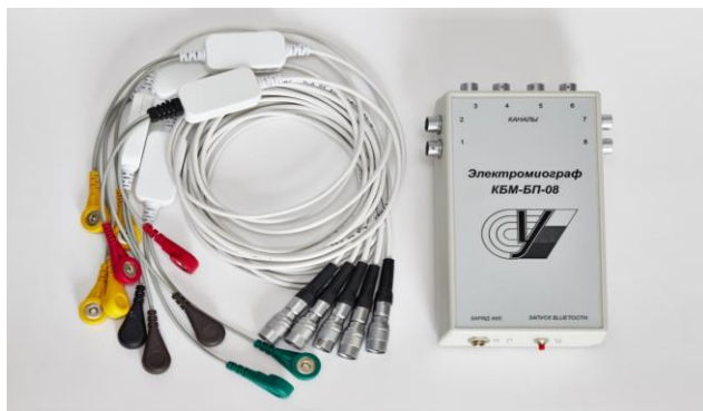
Рисунок 1 – Беспроводной многоканальный электромиограф и комплект накожных электродов с предварительными усилителями.
