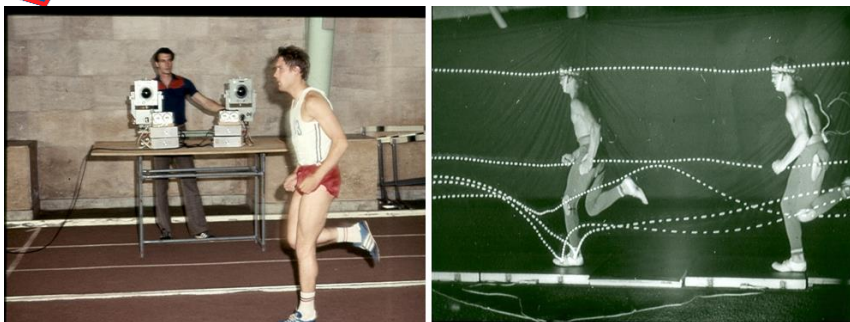
Рисунок 3 – Методика пространственной фотоциклосъемки.
