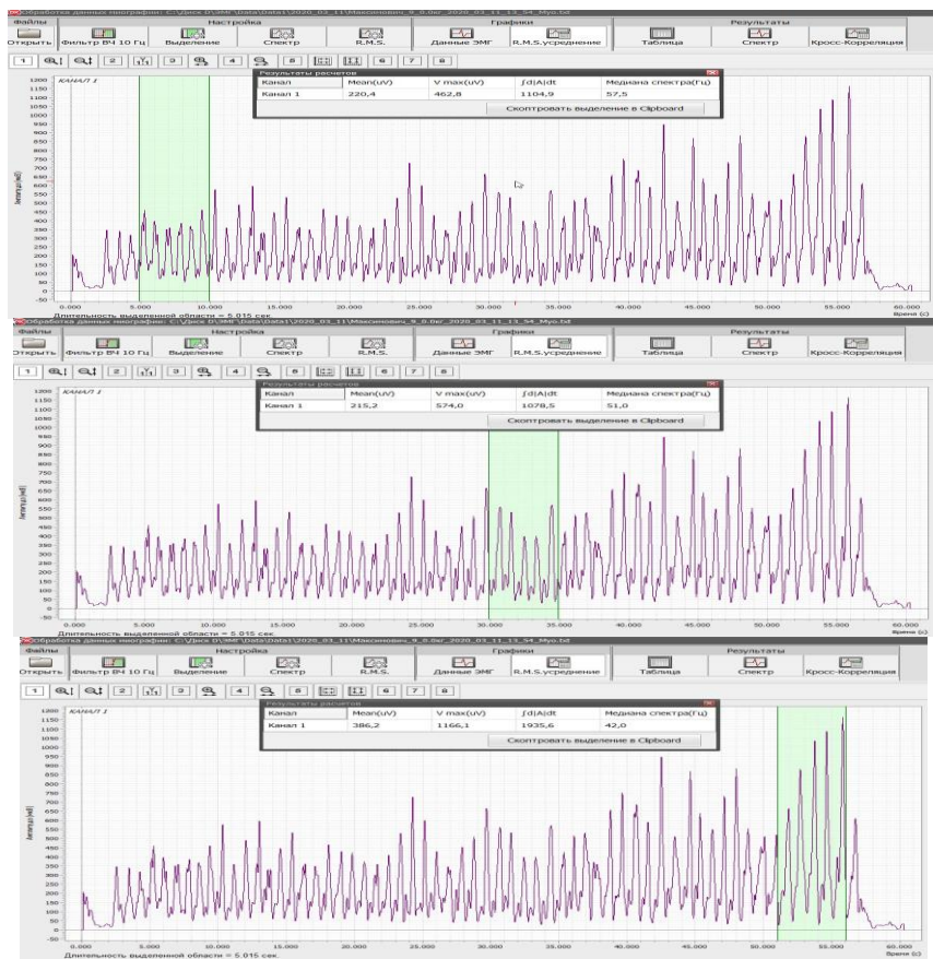
Рисунок 4 – Изменение показателей интегрированной ЭМГ и медианного значения спектра ЭМГ сигнала трехглавой мышцы плеча при многократном отжимании в упоре лежа.
