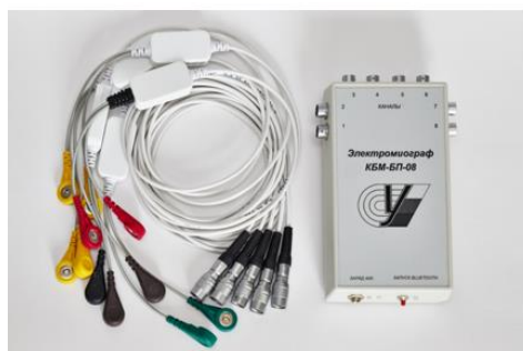
Рисунок 8 – Восьмиканальный электромиограф и положение электродов на теле испытуемого.
