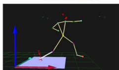
Рисунок 6 – Пространственная видеосъемка и динамометрические платформы.
