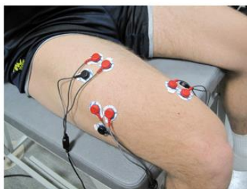
Рисунок 8 – Восьмиканальный электромиограф и положение электродов на теле испытуемого.
