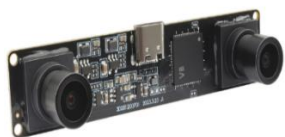
Рисунок 1 - Внешний вид стереокамеры ELP-USB3DGS1200P01-90
