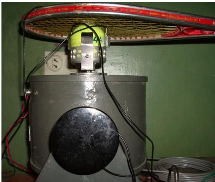
Рисунок 2 - Фрагмент вибростенда для определения динамических характеристик биомеханической системы
