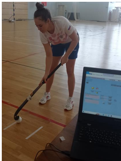
Рисунок. 1 - Исходное положение хоккеистки при выполнении дриблинга на месте и расположение датчика на клюшке
